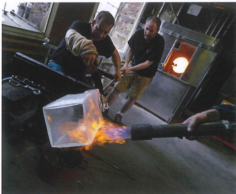
Découpe d'un vase Douglas en verre tout juste soufflé-moulé (design de François Azambourg). GUY REBMEISTER
